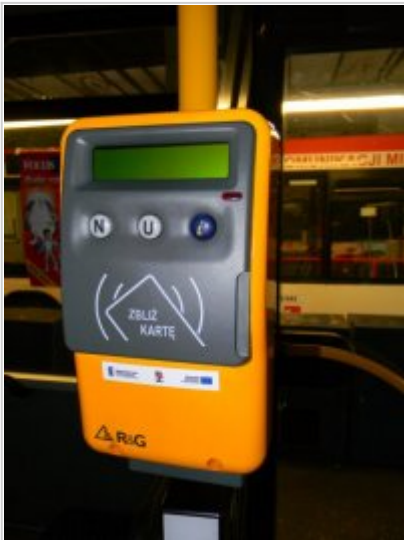
Montaż urządzeń - kasownik doładowujący
